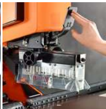
Montaje sin herramientas de los cabezales portabrocas.
